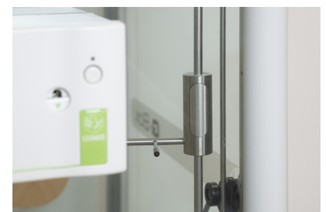
Arm mit Schnellverschluss für Einhandbedienung.
